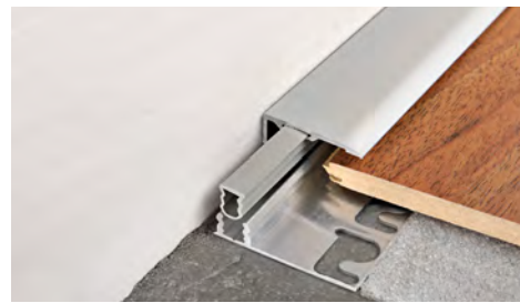
TOP ALU.+PERFIL PIN+BASE 40 ALU. AGUJERADA (6 acabados aluminio anodizado, 3 solo bajo pedido) thermo empaquetado - Unidades de 2,7 M de largo paq. de 20 UDS - 54 M (PIN 11, 15, 17 - 40,5 M) (PIN 19 - 27 M)
