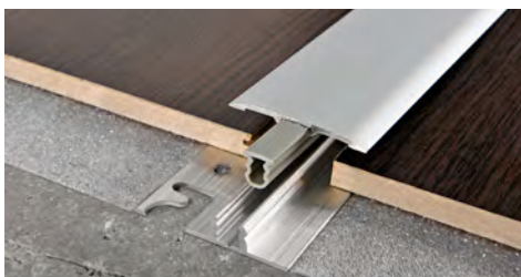
TOP ALUMINIO+PERFIL PIN EN PVC+BASE 45 ALUMINIO AGUJERADA (6 acabados aluminio anodizado, 3 solo bajo pedido) thermo empaquetado Unidades de 2,7 M de largo - Paq. de 20 UDS - 54 M (PIN 17, 19 - 40,5 M)
